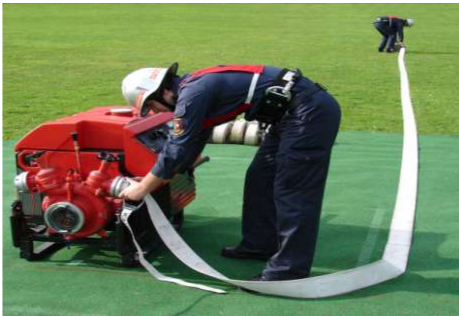
Abb.17: Ankuppeln und Auslegen des ersten B- Schlauches
