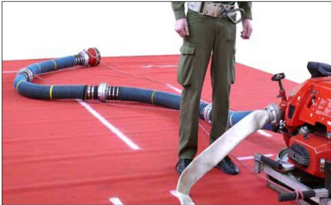
Abb. 16: Befestigen Saugschlauchleine an der TS
