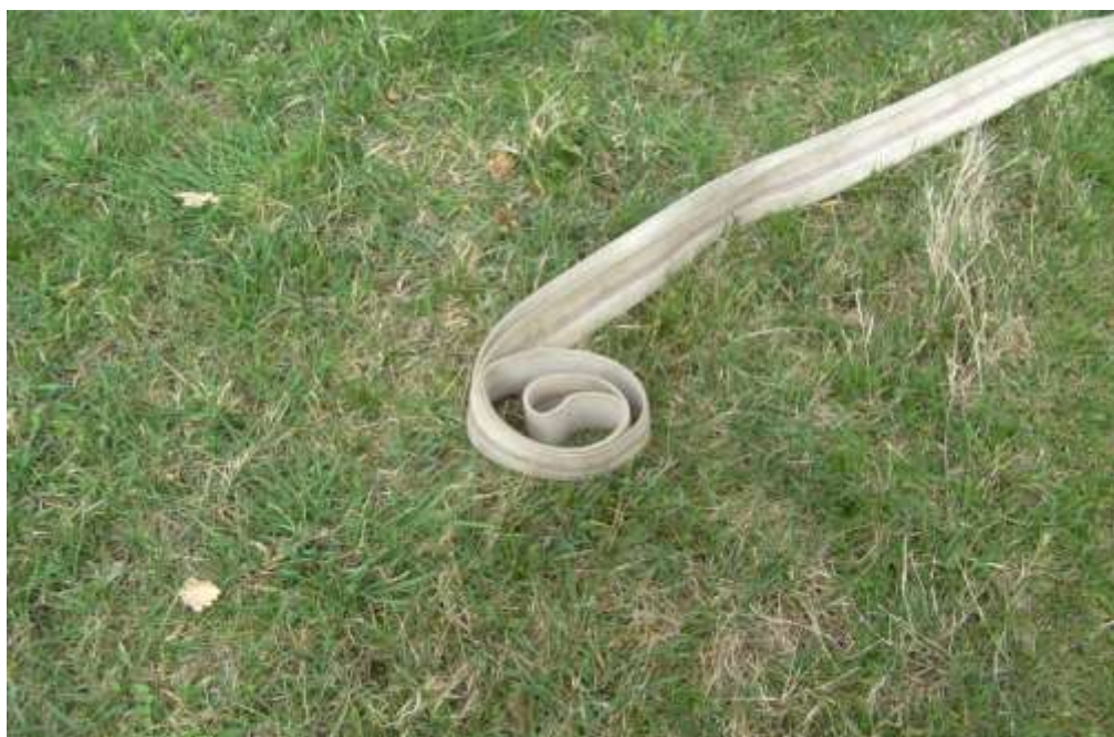
Abb. 21b Schlecht ausgelegter Druckschlauch „Schnecke“
