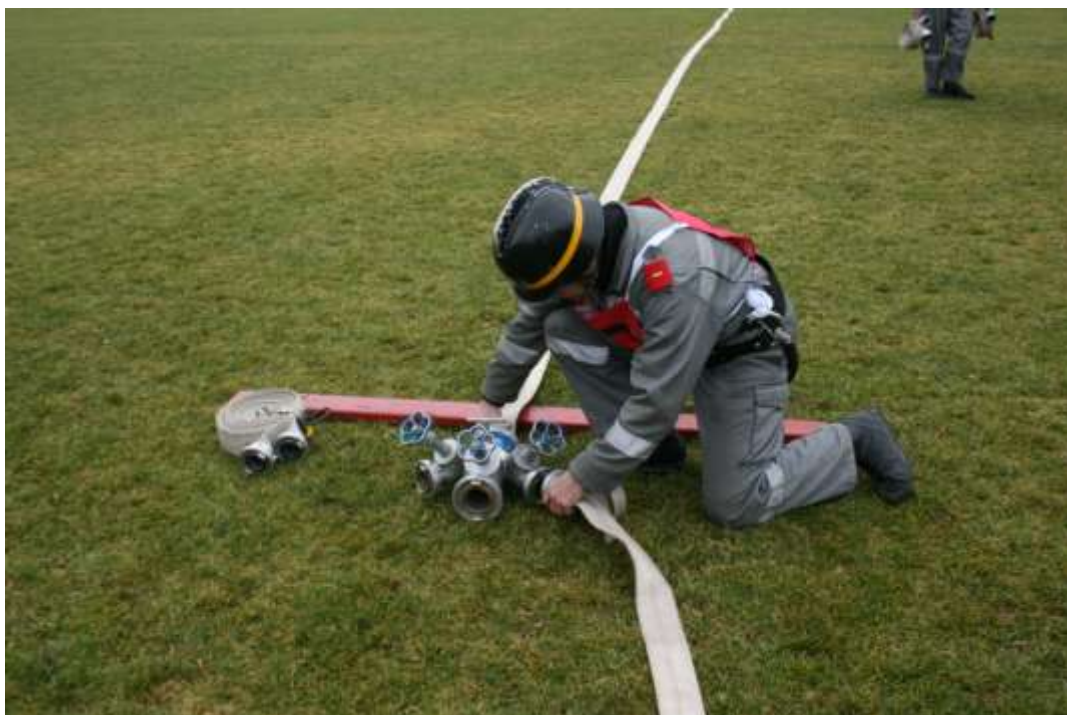
Abb. 20 Ankuppeln des C und B Schlauches an den Verteiler
